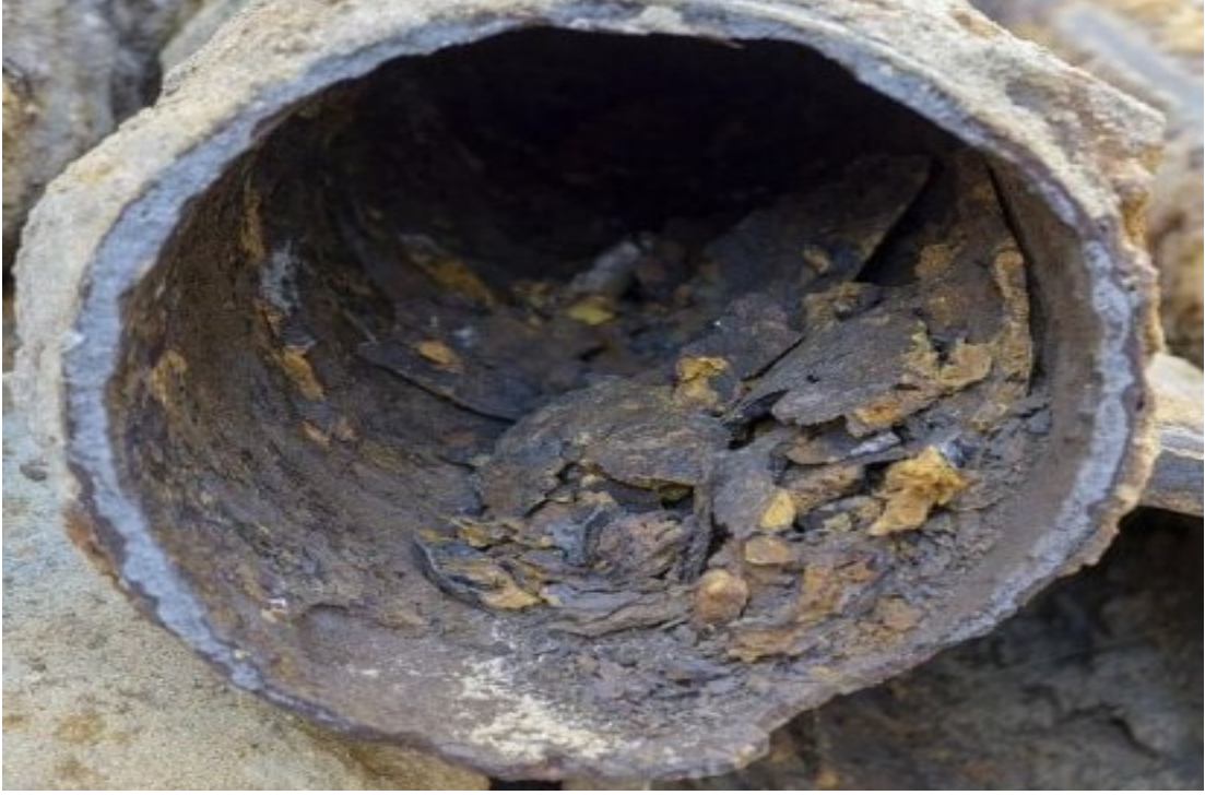
الشكل (1) صورة لتآكل أحد الأنابيب التي تم إزالتها من خطوط التوزيع.
