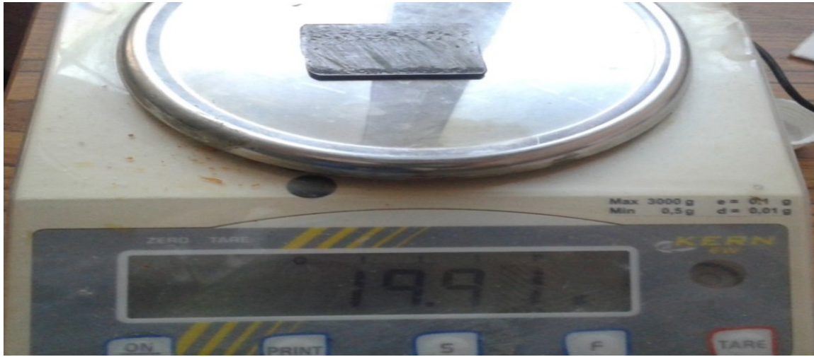
الشكل (4) طريقة وزن العينات والميزان المستخدم.
